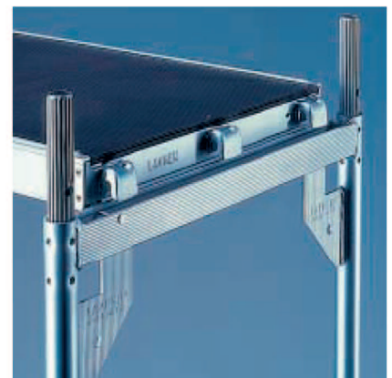
Три фіксуючих виступи на помості легко та безпечно входять у спеціальне заглиблення рами
